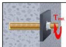
10. Après le durcissement total, la partie ajoutée peut être installée selon le couple max. (Tableau B1) en utilisant une clé dynamométrique étalonnée.
