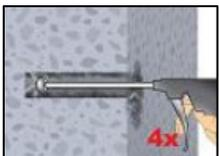
Pour des trous de plus de 20 mm ou d'une profondeur supérieure à 240 mm, de l'air comprimé (min. 6 bar) **doit** être utilisé.
