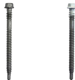
Bi-métal (Inox A2 / Pointe acier) 30 cycles kesternich
